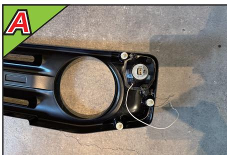
純正グリルを取り外し、純正グリルのフロントウインカー、クリップを本製品に取り付けます。
