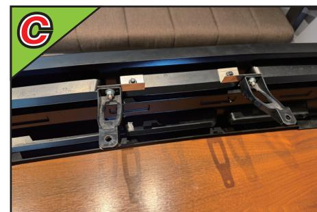
純正グリルから車体に取り付けするステーを外し、付属の取付ステーにねじとナットを使用して取り付けます。
