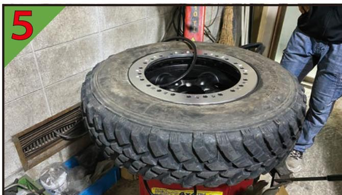
⑤ビードリングが締まるにつれてボルトにゆるみが出ますので、④の作業を何度か繰り返します。
