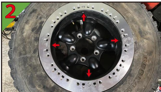
②はめ込んでいないタイヤのビート部を挟み込むようにビードリングを付属の呼びボルトで仮止めします。
